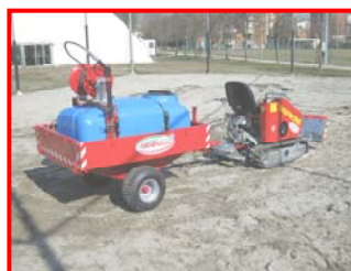
Rimorchietto leggero con cisterna da lt. 300 e pompa ad alta pressione Attrezzature speciali a richiesta
